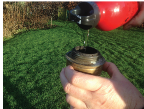
Spritten kan hældes i brænderen UDEN proppen skruet af flasken. Selvom spritten antændes, kan dampene i flasken ikke antændes og trække brændende sprit ud af flasken.
